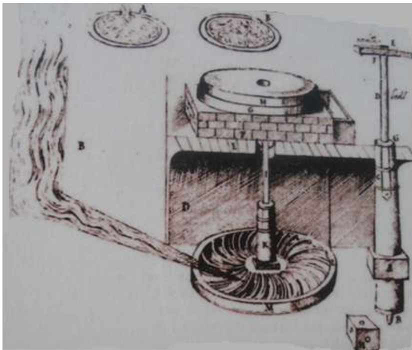
Fig. 13. Dibujo esquemático sobre el funcionamiento de un molino de cubo
